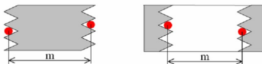
Рис. 1. Внешняя резьба с проволочками и внутренняя резьба с шариками
